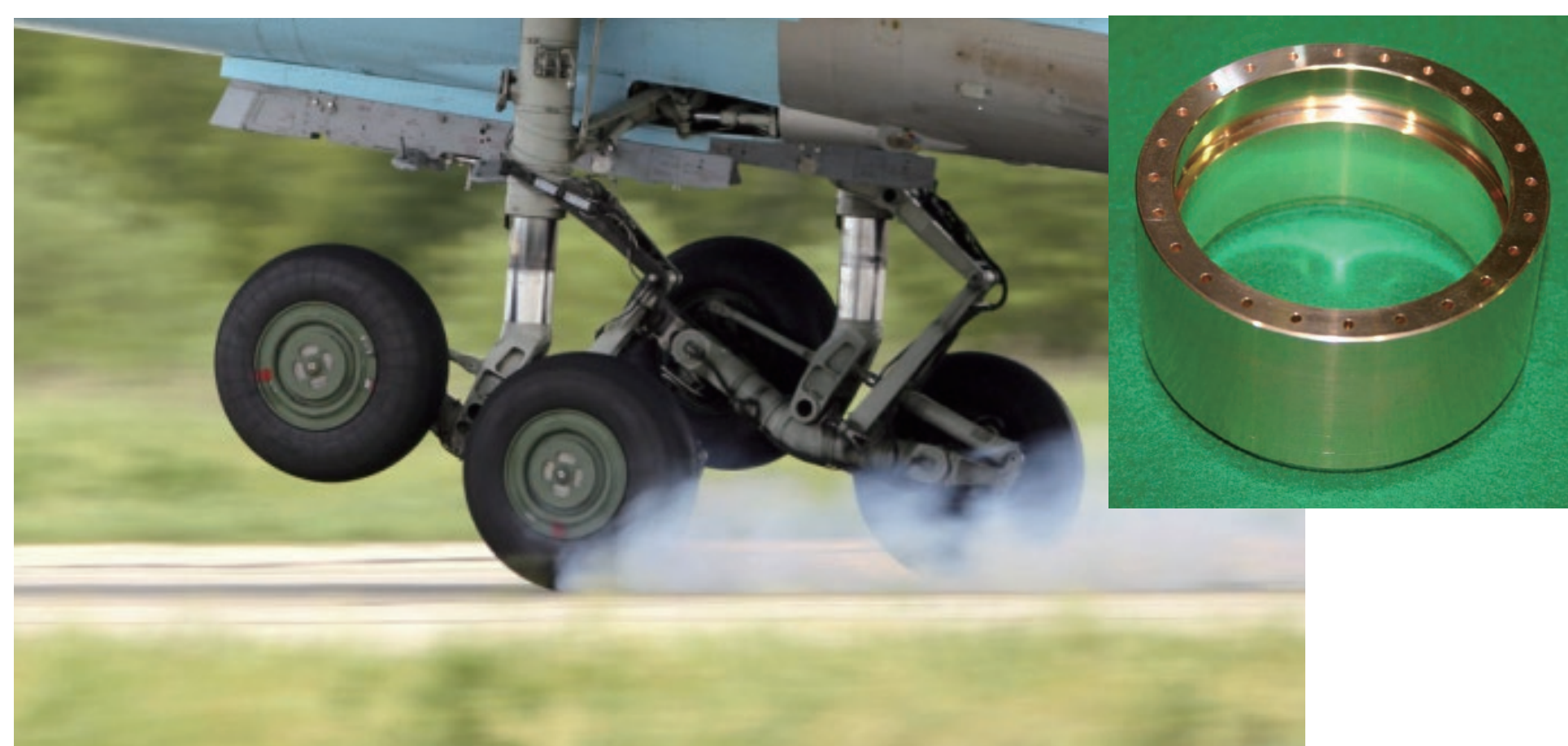
航空機用ブッシング, ベアリング 耐磨耗 (鉄同士のカジリ防止)
